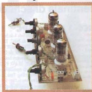
Circuito classico che impiega i più famosi doppi triodi della storia della amplificazione per strumenti elettrici, ma ancora molto ricercato.
