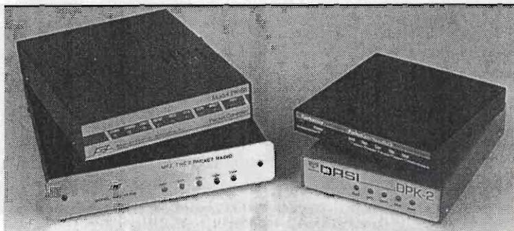
figura 1 - Ecco la foto di quattro TNC molto popolari tra i radioamatori: a sinistra il PK-88 della AEA e sotto il MFJ-1270J; a destra il Kantronics KPC-3 e sotto il DPK-2 della DRSI.
